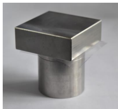
ภาพประกอบที่ 2 แสดงการฉีดวัสดุพิมพ์ปากลงบนแม่หล่อโลหะ (ซ้าย) และปิดทับด้วย แผ่นพอลิเอทิลีน และแผ่นโลหะเรียบ (ขวา)
