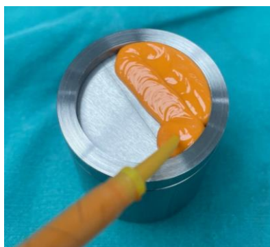
ภาพประกอบที่ 2 แสดงการฉีดวัสดุพิมพ์ปากลงบนแม่หล่อโลหะ (ซ้าย) และปิดทับด้วย แผ่นพอลิเอทิลีน และแผ่นโลหะเรียบ (ขวา)
