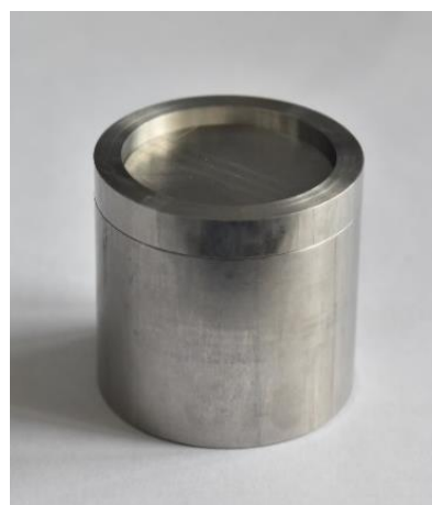
ภาพประกอบที่ 1 แสดงสัดส่วนขนาดของเบ้าหล่อโลหะและขนาดของร่องที่ปรากฏบนบล็อกตามเกณฑ์ของสมาคมทันตแพทยอเมริกันหมายเลข 19
